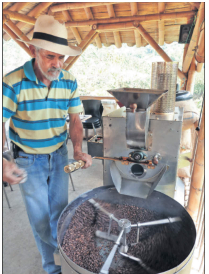
Erst bei der Röstung bei 220 Grad Celsius entfaltet die Kaffeebohne ihr typisches Aroma.
